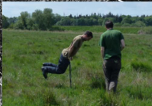
**Kleine Fotos:** Moorforscher arbeiten mit einem Erdbohrstock, um die Torfschichten zu untersuchen.
